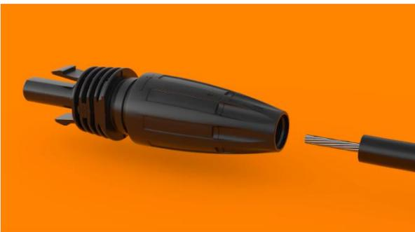
2. Der abisolierte Leiter wird von hinten so weit in den Stecker eingeführt, bis es „Klickt“. Dabei wird der abisolierte Teil der Leitung in einen Trichter geführt, der alle Litzen unter eine Metallfeder schiebt, so dass keine Litzen abstehen können.
