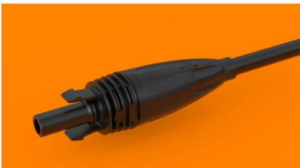
5. Am Ende muss die Verschlusskappe des Steckers fest angezogen werden, um den Schutz gegen Staub und Feuchtigkeit (IP68) sicherzustellen. Im zugeschraubten Zustand muss der Stecker nun mindestens 400N Zuglast aushalten.
