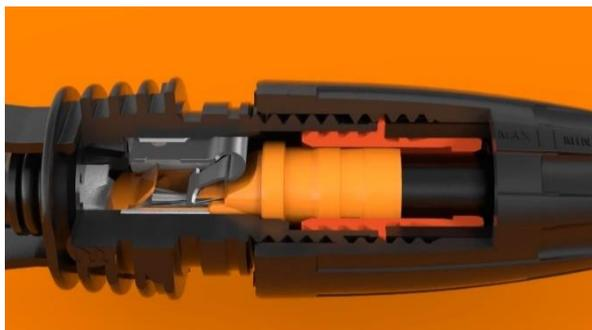
3. An einem bestimmten Punkt löst diese Feder aus und quetscht die Litzen mit einer sehr breiten Auflagefläche, so dass ein sehr geringer Übergangswiderstand entsteht. Die Elektromechanische Verbindung ist damit hergestellt.
