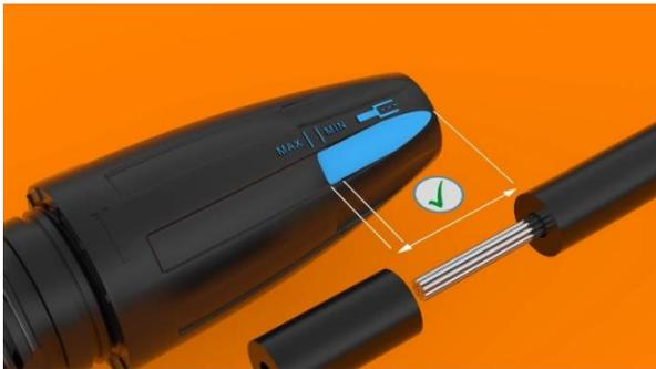
1. Wie beim Crimp-Stecker wird zunächst die Leitung abisoliert. Die Abisolierlänge beträgt beim PV-Stick 15-16mm und kann einfach in den Einkerbungen an der Verschlusskappe des Steckers kontrolliert werden.
